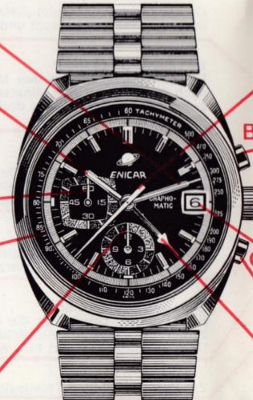
Trotteuse du chronographe (centrale); elle est mise en route, stoppée et ramenée à zéro au moyen des boutons-poussoirs B + C.
